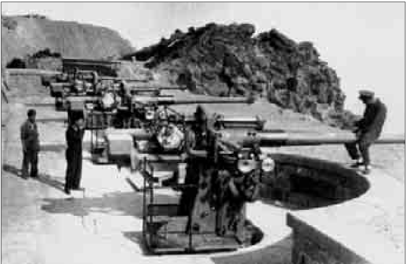
Lám. 134: Las baterías antiaéreas –en este caso la de Cabo Negrete– se dispusieron en montaje lineal. Con los avances técnicos de la nueva arma, se hizo necesario cambiarlas.
