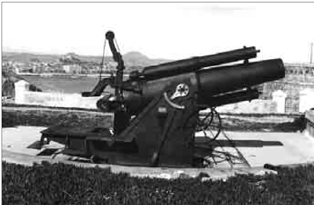
Lám. 71: Otra fotografía de los obuses Ordóñez de 24 cm emplazados en Fajardo, en la cual se puede apreciar la grúa de carga de los proyectiles y el sistema de puntería, así como la técnica para amortiguar el retroceso.
