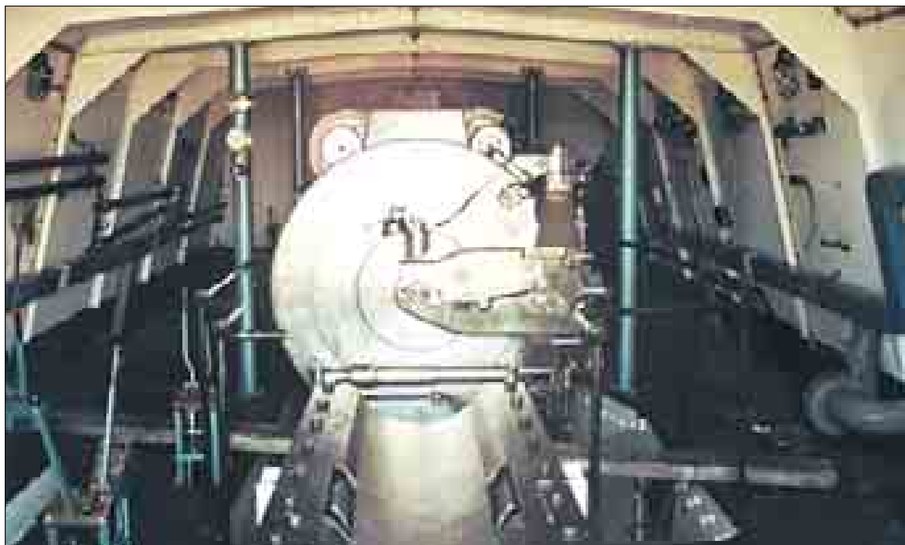
Lám. 188: Batería Vickers 38'1: cierre de carga del tubo de 38'1. Un gigantesco bloque de bronce. Mahón.
