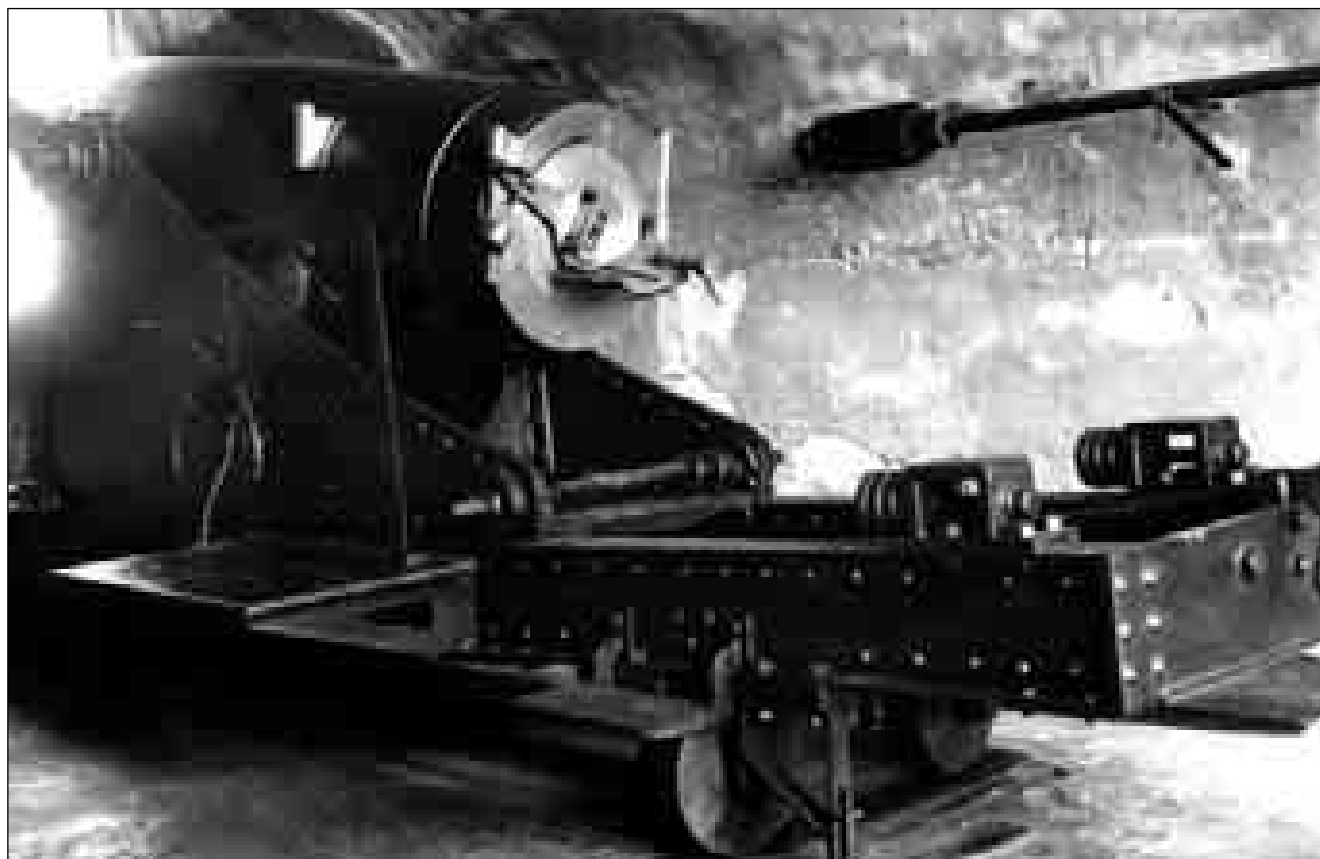
Lám. 66: Magnífica imagen de uno de los seis cañones de hierro Ordóñez modelo 1885 de 150 mm y 34 calibres que artillaron la batería de Santa Ana Acasamatada. Obsérvese el cierre de la recámara y el sistema de puntería.
