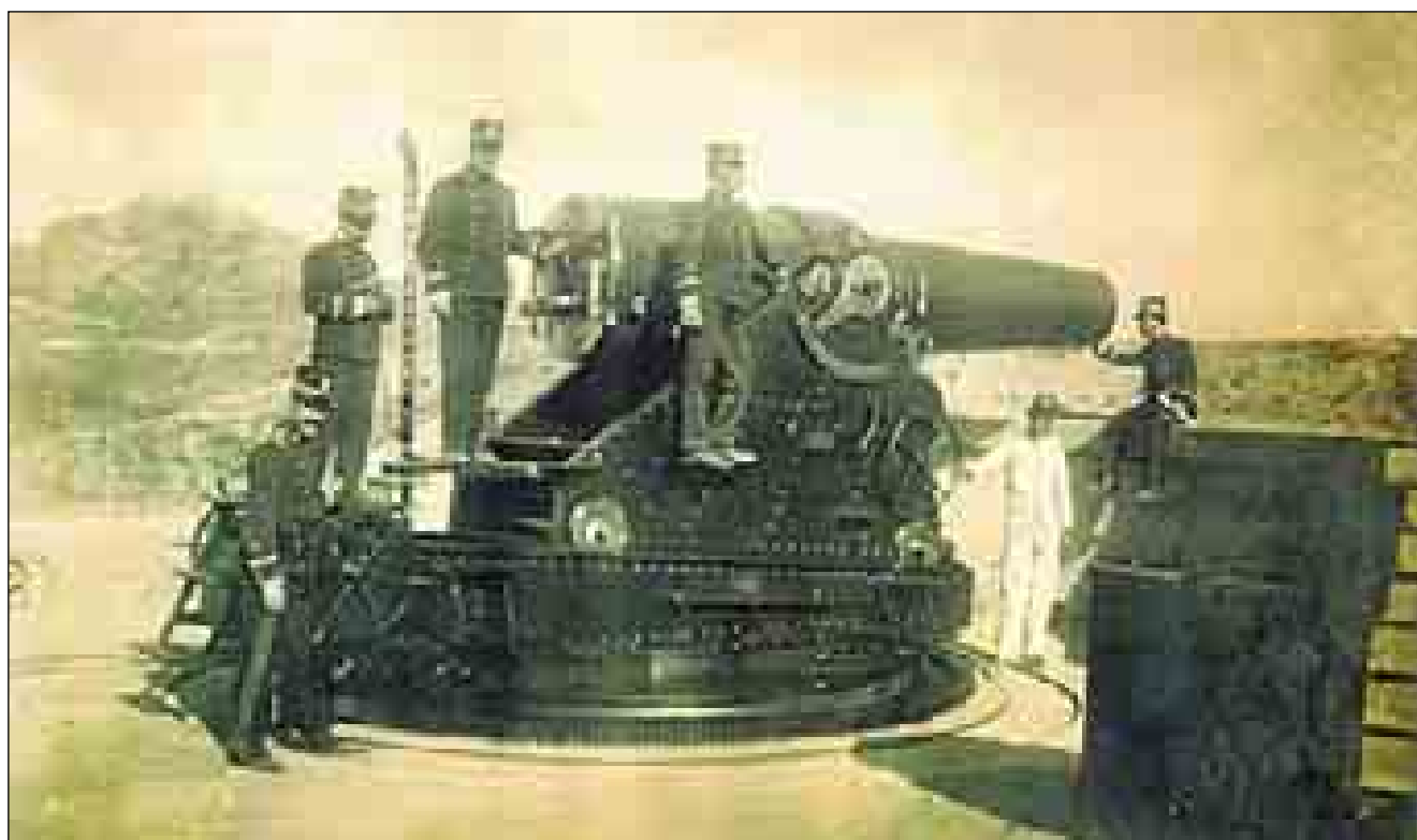
Lám. 54: La batería Fajardo nº 3 fue dotada de cuatro obuses de hierro sunchado Ordóñez modelo 1892, de 30'5 cm y 13'7 calibres. En la imagen, una de las piezas (al fondo, San Julián), que lanzaban un proyectil de 275 k a 9.400 m. Su velocidad de disparo, a pesar de ser una pieza moderna de retrocarga, era lenta, al igual que los Krupp, y se solía efectuar un tiro cada cuatro minutos.
