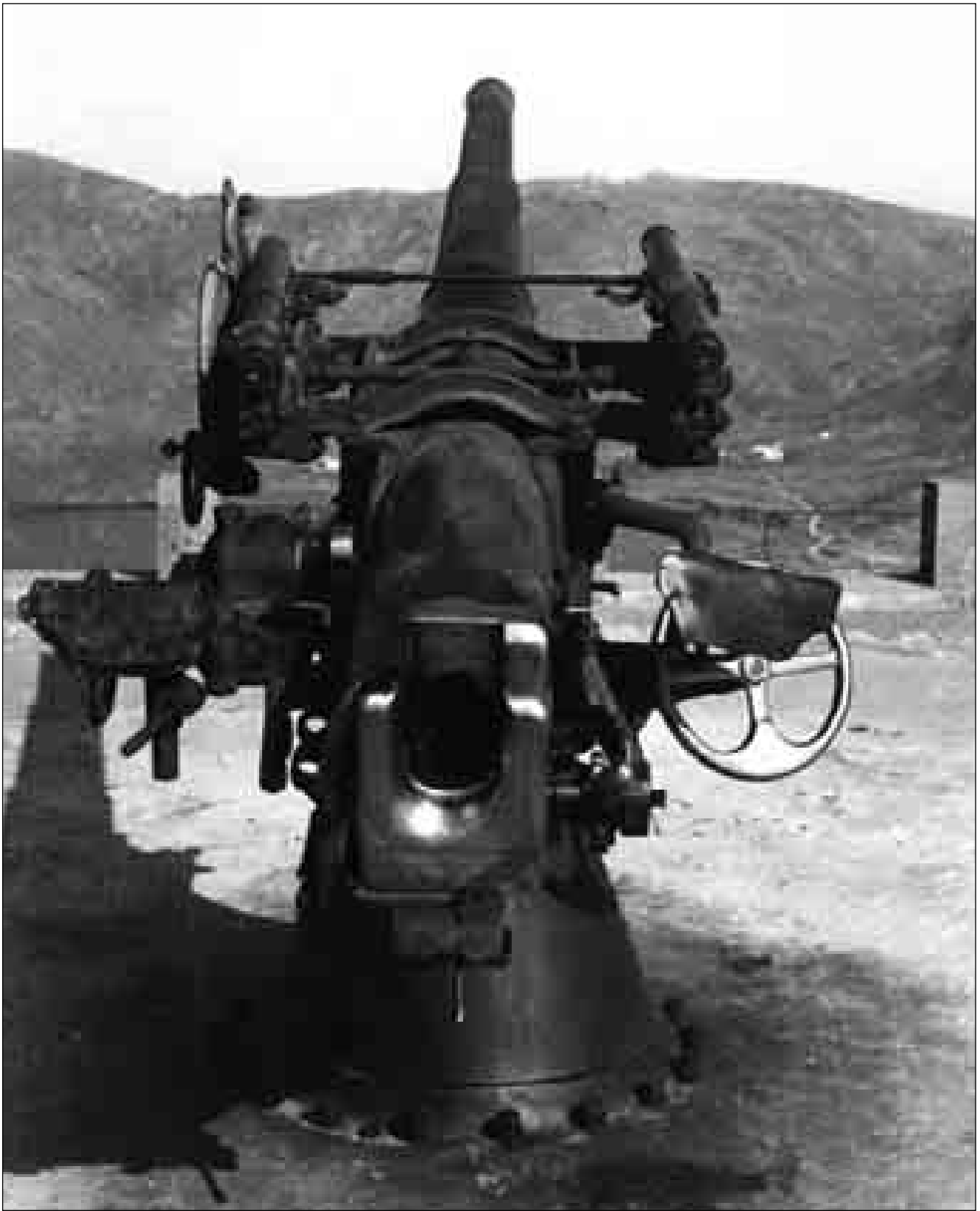
Lám. 156: Una de las cuatro piezas Vickers-Armstrong, de 76'2 mm emplazadas en Aguilones posó aquí para la cámara con su recámara abierta, donde incluso se pueden leer sus características.
