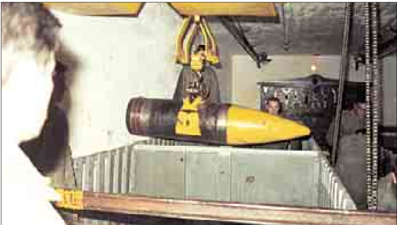
Lám. 187: Batería Vickers 38'1: sacando el enorme proyectil de casi una tonelada. Mahón.
