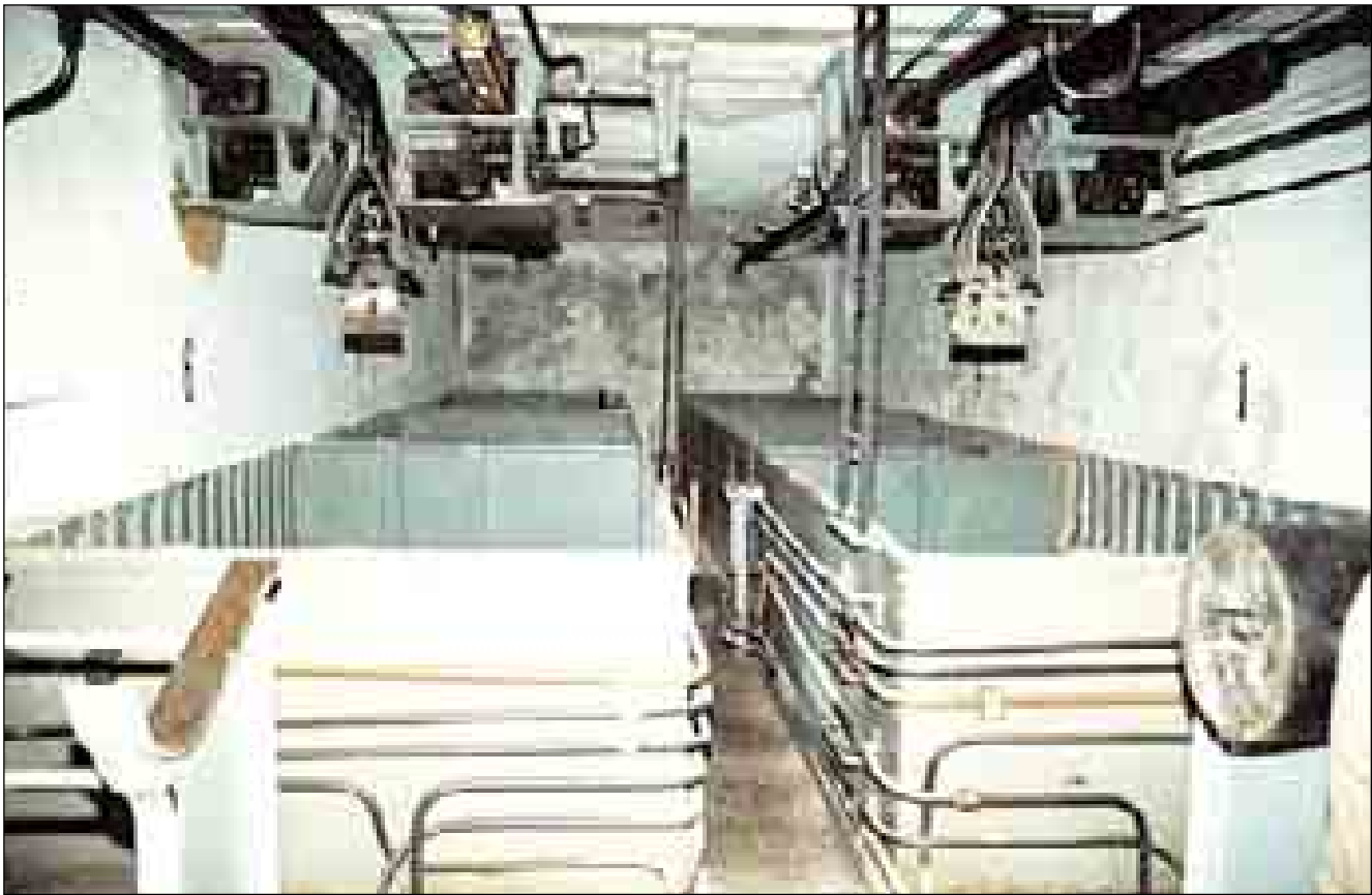
Lám. 186: Batería Vickers 38'1: chilleras de proyectiles y mecanismo de carga. Mahón.
