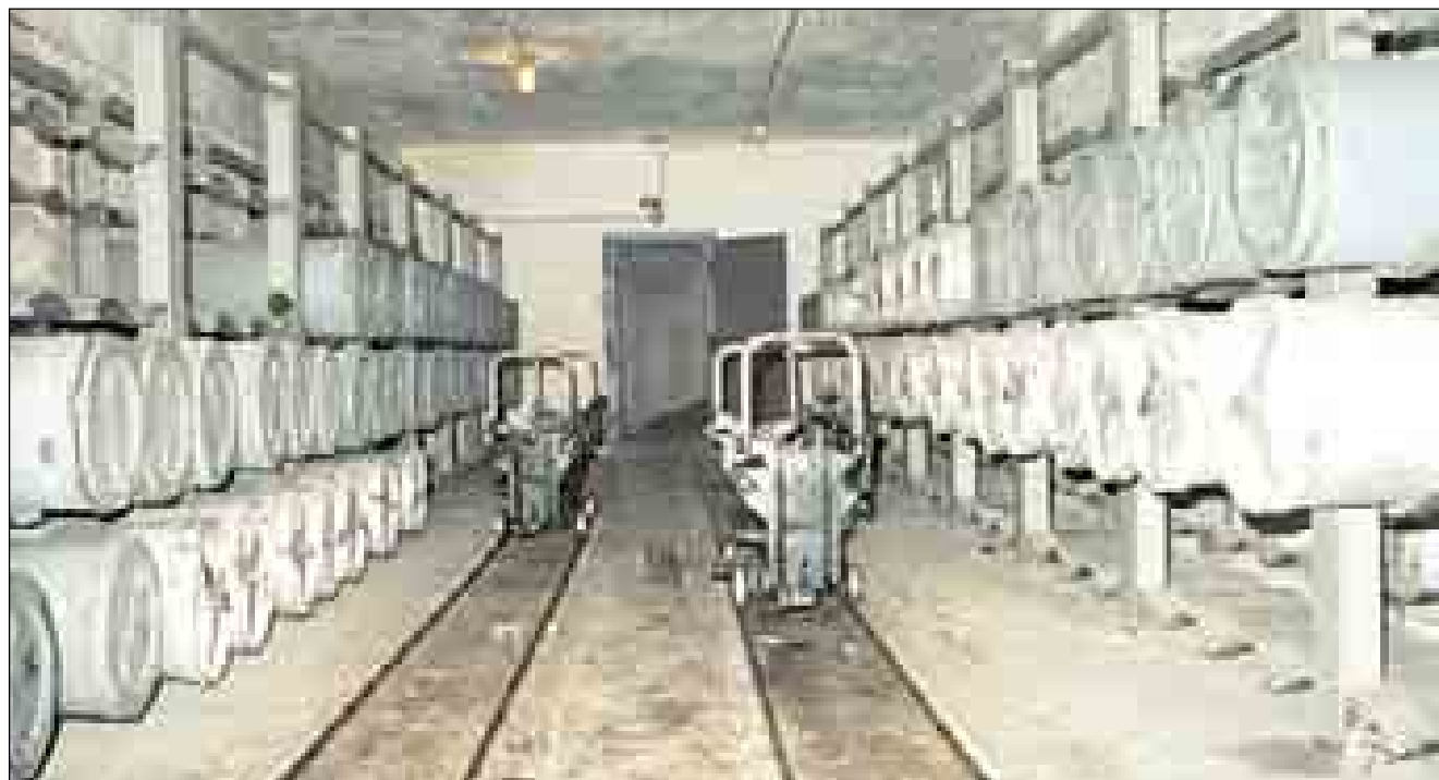
Lám. 185: Batería Vickers 38'1: imagen del depósito de cargas de proyección en Mahón.
