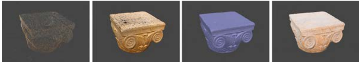
Figura 5. Proceso de modelado tridimensional, a) Nube de puntos de la correlaci3n autom3tica; b) Nube de puntos densa; c) Modelo de Malla; d) Modelo con la textura real. (Elaboraci3n propia)
