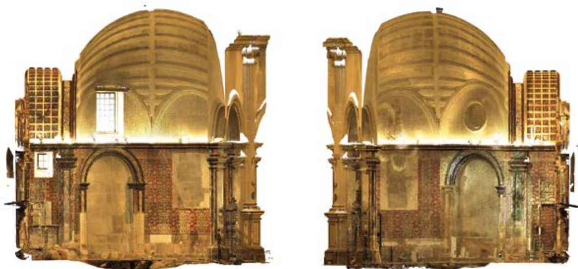
Figura 5. Nube de puntos de los alzados interiores de la capilla Virgen del Alcázar. Colegiata San Patricio (Lorca). (Fuente: Arquivera, www.arquivera.com)
