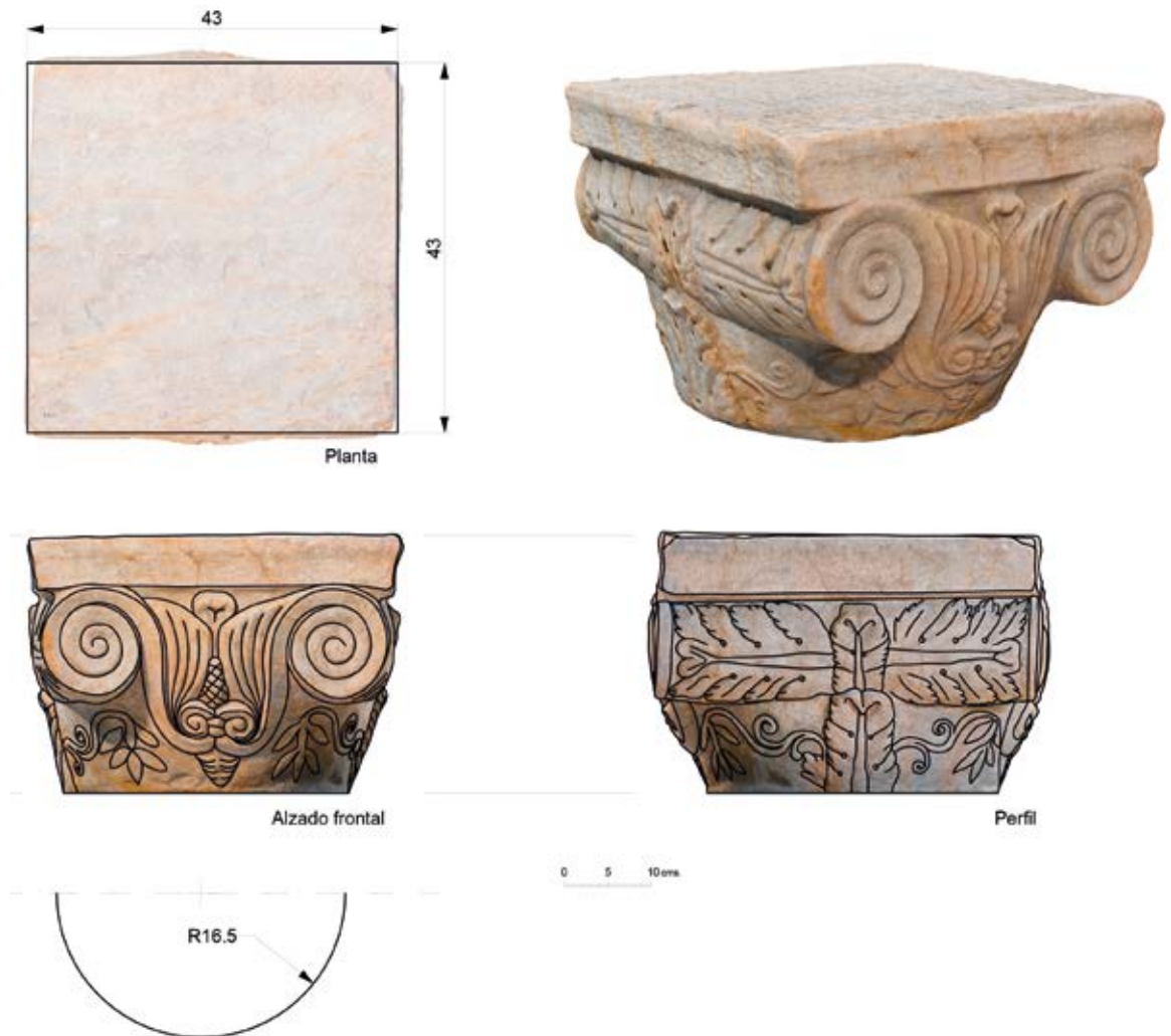
Figura 6. Vectorizaci3n de los dos alzados diferentes del capitel, sobre la ortoimagen del mismo. (Elaboraci3n propia)
