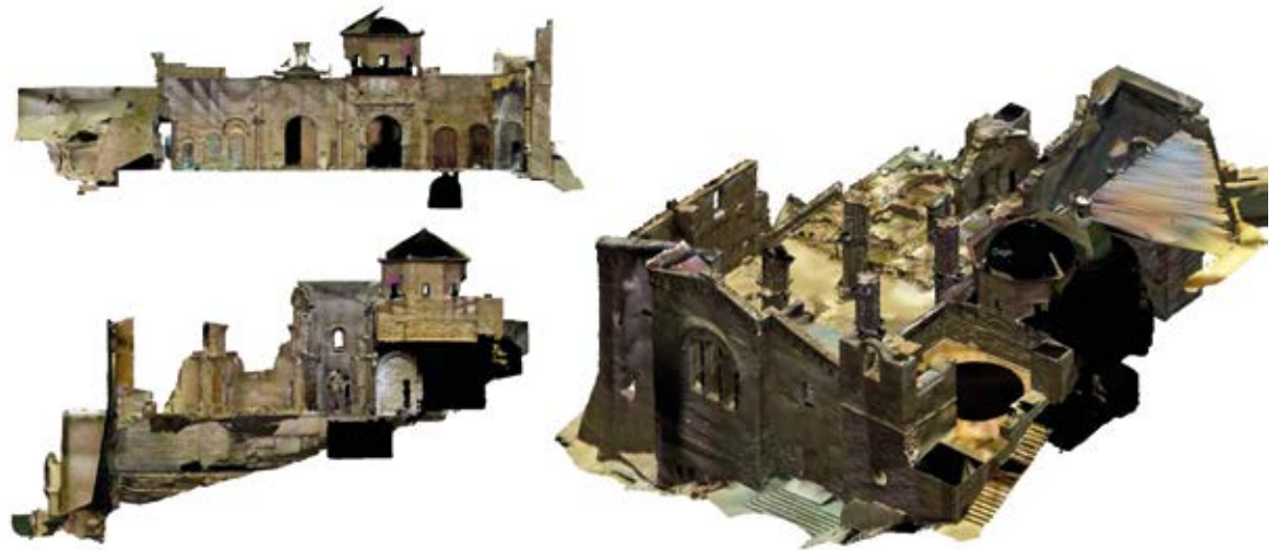
Figura 5. A la izquierda, dos de los alzados interiores del templo con la texturización final. El superior con las fachadas de las capillas laterales; el inferior en sección por la cisterna romana. A la derecha, modelo tridimensional final con la malla del conjunto texturizada.
