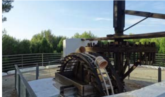
Figura 7. Vista de las dos ruedas de la noria tras su restauración en 2019, con las maromas y arcabuces montados.
