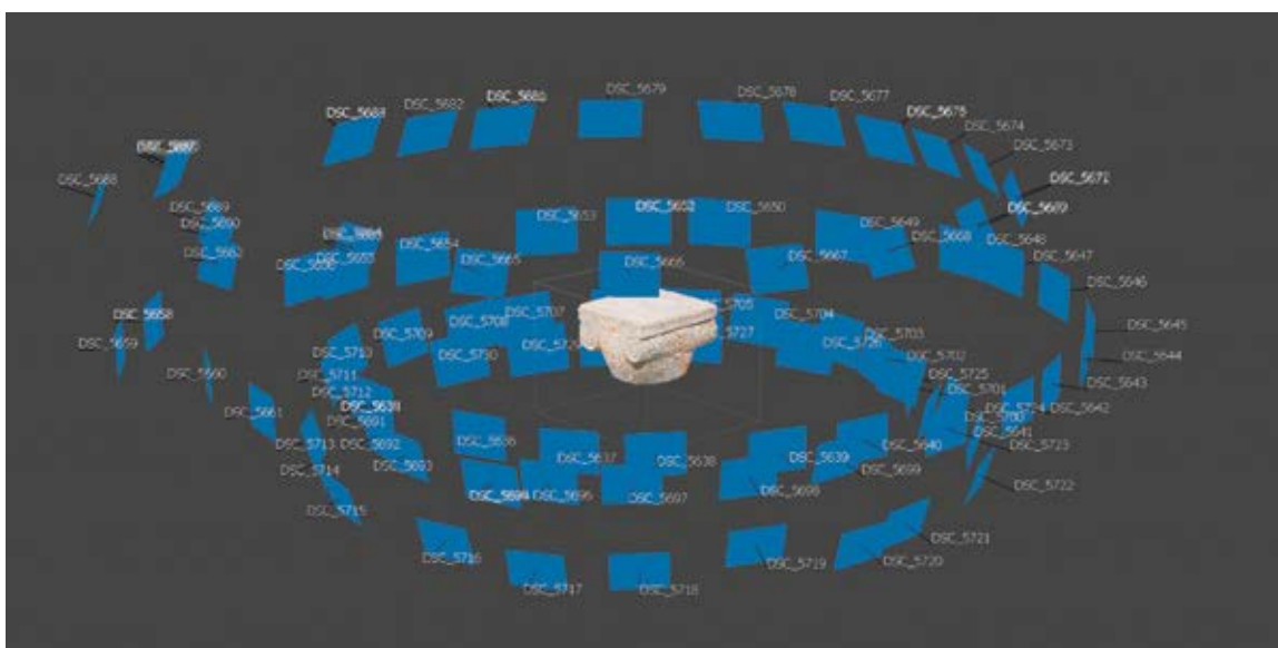
Figura 4. Resultado de la orientación relativa. Anillos de toma de las fotografías. (Elaboración propia)
