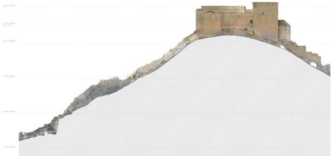
Figura 2. Una de las herramientas de conocimiento generadas por el Plan. Levantamientos fotogramétricos 3D de toda la fortificación. (Plan Director del castillo de Mula)
