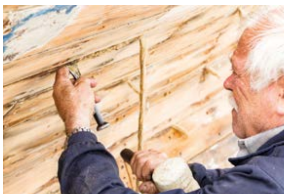
Figura 2. Fotografía de Maestro Carpintero D. Diego Fernández Mateo, carpintero de Águilas, uno de los últimos carpinteros de Ribera de la Región de Murcia calafateando uno de los laúdes de vela latina del Mar Menor en 2018. (Fotografía de D. Ángel Maciá Veas. Asociación Fotográfica Photorouters Cartagena)
