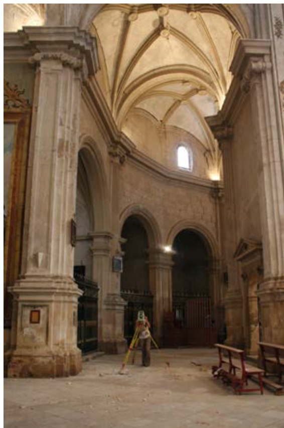
Figura 1. Control geométrico mediante topografía clásica. Colegiata San Patricio (Lorca).
