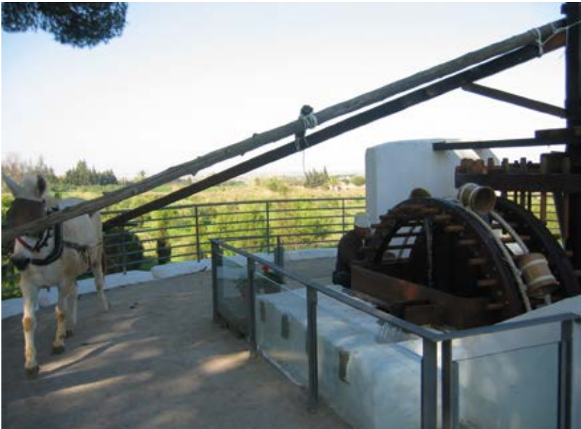
Figura 1. Noria de sangre de Huerto Pío restaurada y en funcionamiento. 2007.
