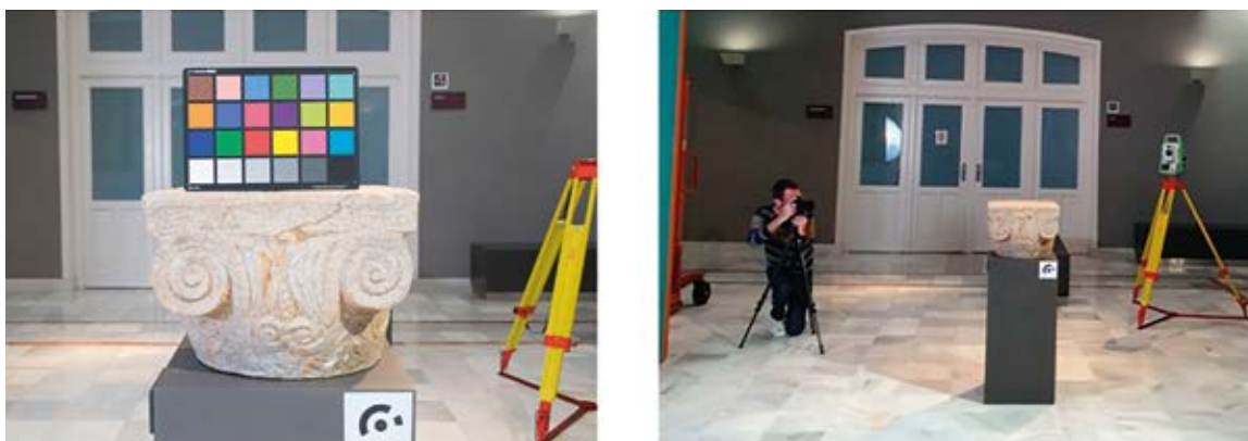
Figura 3. Toma de datos mediante fotogrametría, a) imágenes de la escultura con la plantilla de corrección de color; b) imágenes en el momento de la toma. (Elaboración propia)
