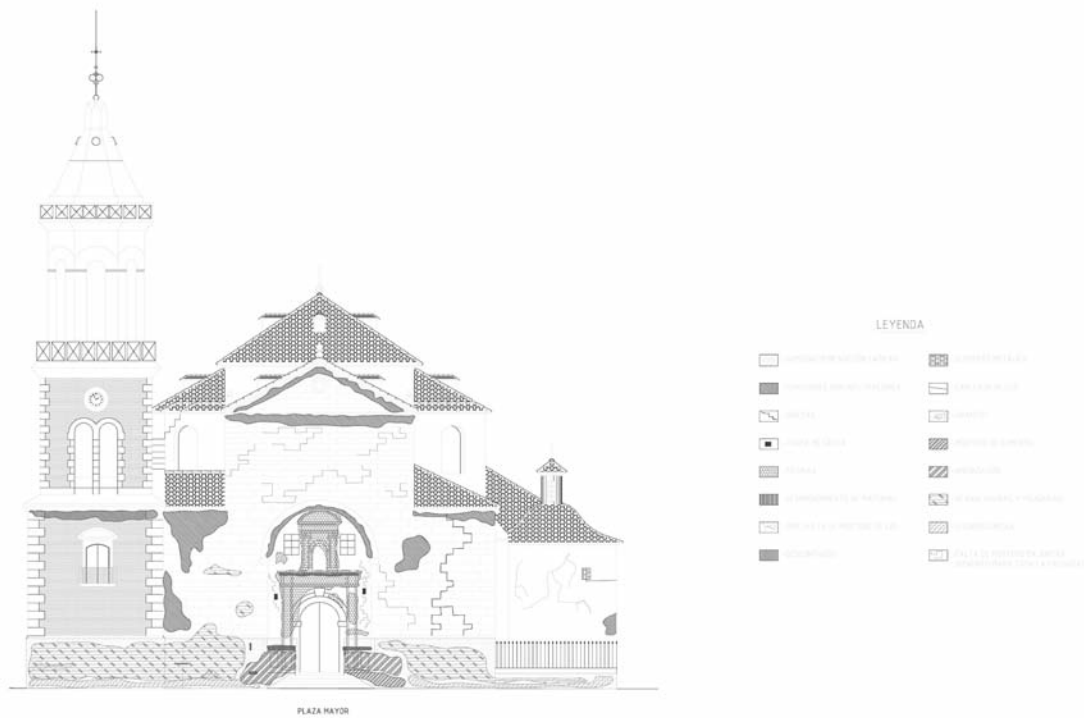
Figura 2. Plano del alzado principal de la iglesia con identificación de las patologías presentes.
