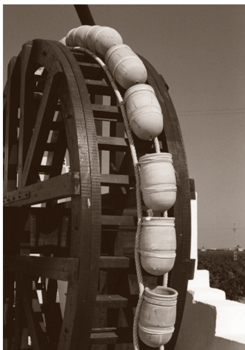
DETALLE DEL TAMBOR Y ARCADUCES DEL MOLINO DE AGUA
