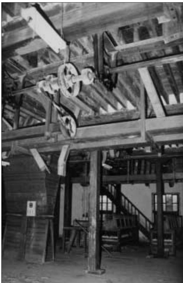
Lámina 8. Vista de maquinaria, depósito de harina en primer término y sasores de limpieza y clasificación de sémolas al fondo
